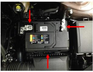
Отвернуть клеммы и крепление АКБ и вытащить АКБ.
