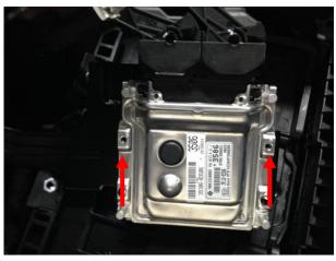
Отвернуть два болта крепления ЭБУ.
