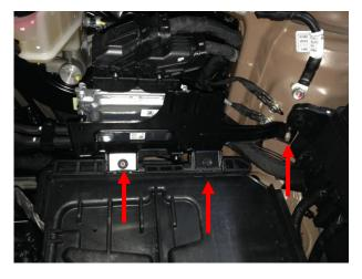
Отвернуть два болта и гайку крепления ЭБУ.
