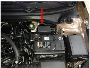
Установить защиту на шпильки, притянуть защиту срывными гайками из комплектации. Закрутить крепеж до отрыва головок.
