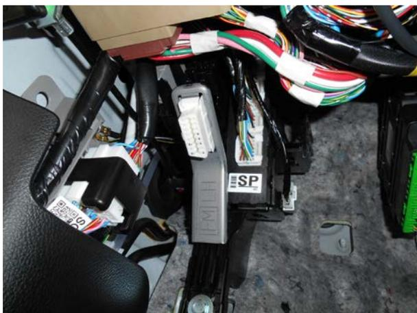
Вытащить разъем OBD из гнезда и снять кронштейн.
