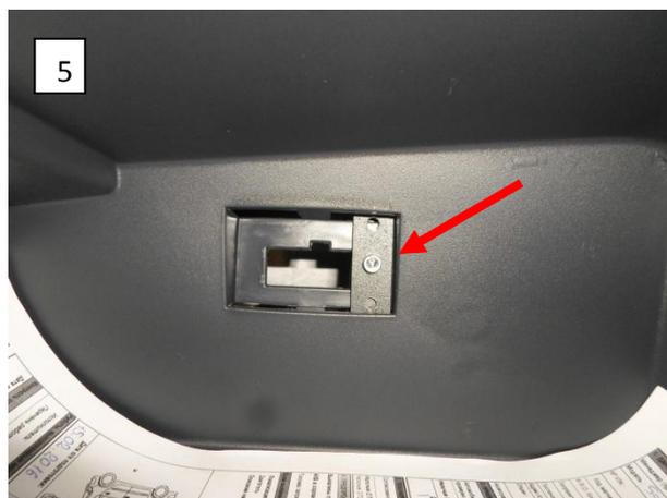
Вытащите диагностический разъем (Фото 2). Соберите крепление замка (Фото 3, 4). Закрепите замок с помощью пластины (Фото 5). Закройте разъем внутри замка (Фото 1).
