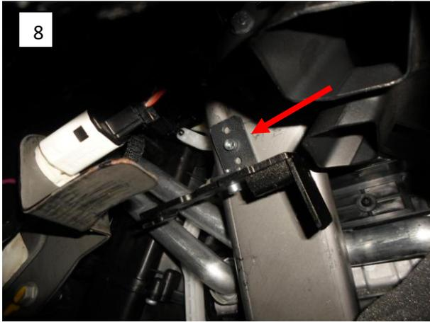
Снять панели (Фото 2, 3). Вытащите диагностический разъем (Фото 4, 5). Соберите крепление замка (Фото 5). Использовать пластину, как закладную гайку; закрепите замок (Фото 7, 8). Закройте разъем внутри замка (Фото 1).
