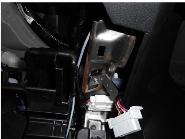
Установить крепёж из набора на кронштейн кузова в соответствии с ранее намеченным положением замка.
