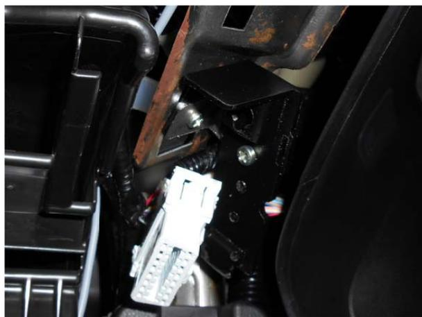
Закрепить основание замка через штатные отверстия и разместить на нем диагностический разъём.
