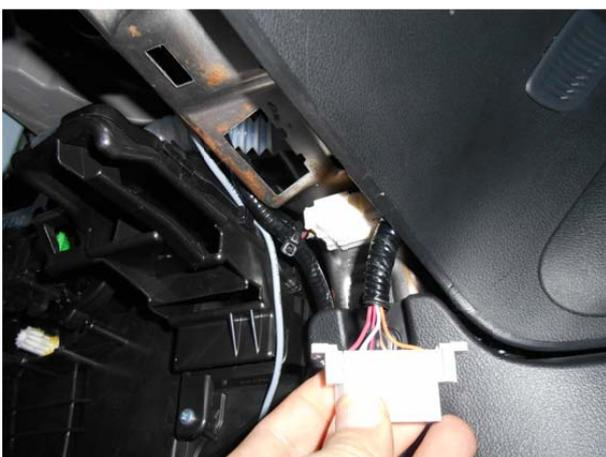
Вытащить диагностический разъём из штатного места установки и определить длину проводов.
