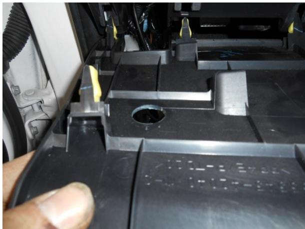
Разметить и выполнить отверстие в панеле.
