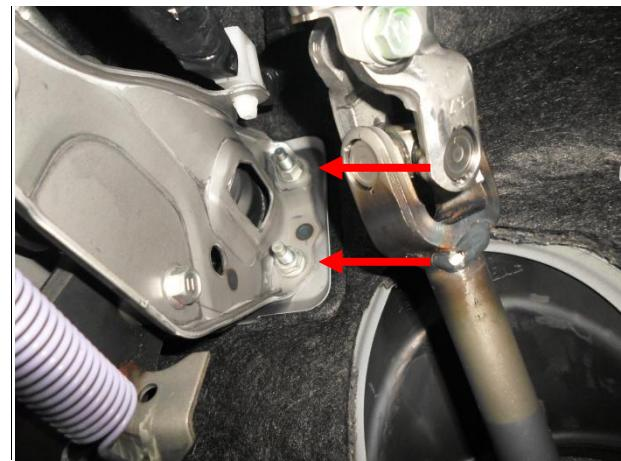
Отвернуть 2 гайки.
