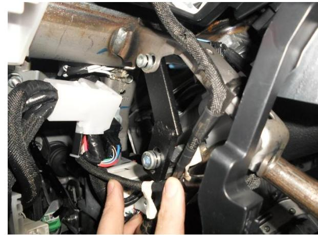
Установить регулировочную пластину.
