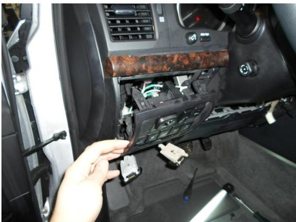
Снять панель, отсоединить фишкы.
