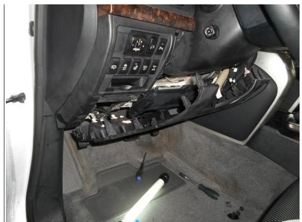
Снять панель, отсоединить фишкы.
