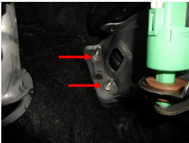
Отвернуть 2 гайки.
