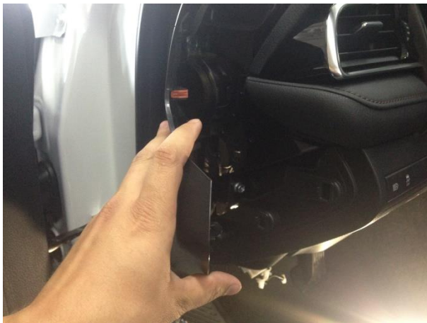
Снять боковую панель.
