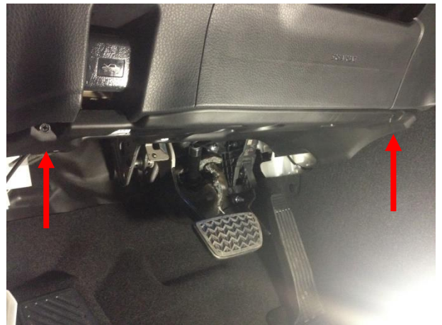
Вывернуть 2 самореза. Снять панель, отсоединить фишки.
