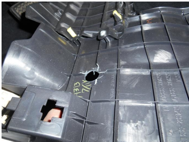
Разметить и выполнить отверстие в панели.
