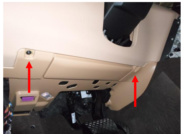
Вывернуть 2 болта. Снять панель, отсоединить фишки.
