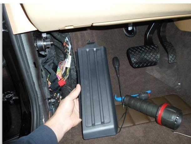
Снять накладку подножки.
