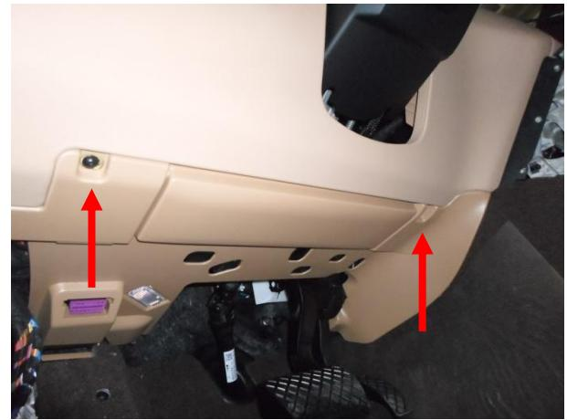
Вывернуть 2 болта. Снять панель,
