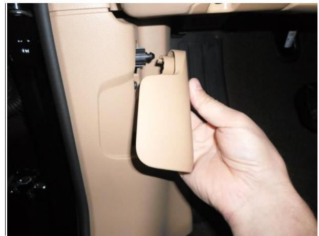
Снять ручку открывания капота.
