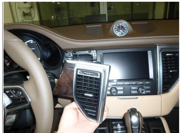
Спец. инструментом выдернуть дефлектор.
