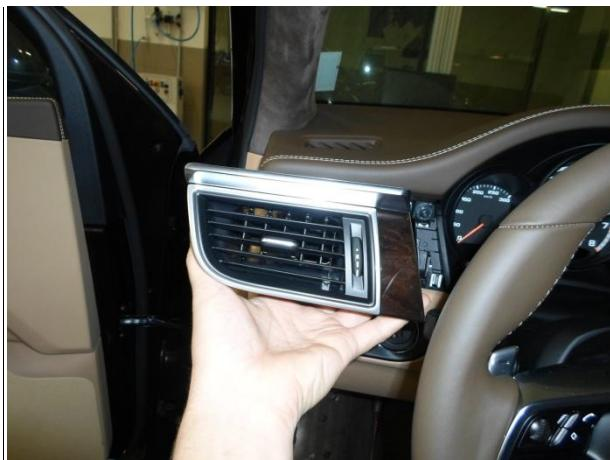
Спец. инструментом выдернуть дефлектор.
