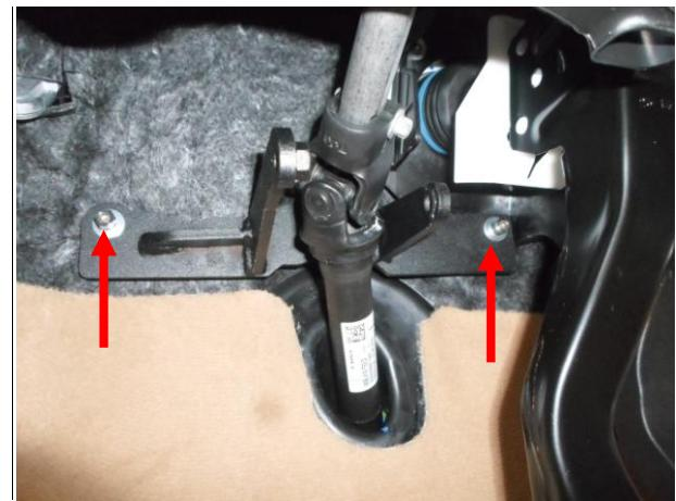
Установить и притянуть нижнее крепление срывными гайками М6.
