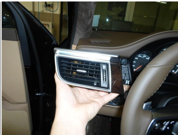
Спец. инструментом выдернуть дефлектор.
