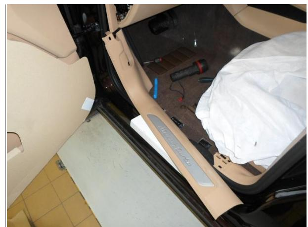
Снять накладку порога.
