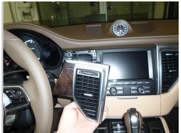
Спец. инструментом выдернуть дефлектор.
