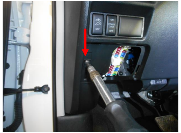
Снять панель и вывернуть саморез.
