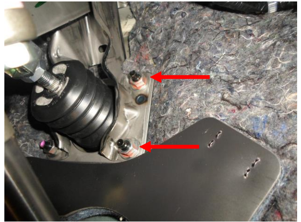
Отвернуть 4 гайки крепления вакуумного усилителя тормозов.
