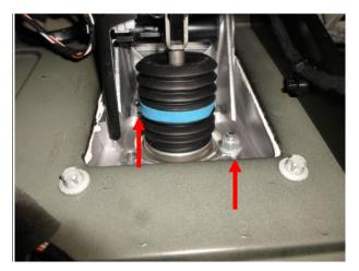
Отвернуть 2 гайки.
