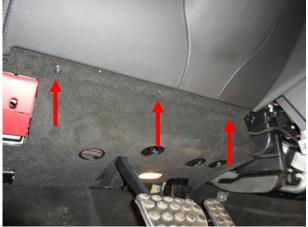
Вывернуть саморезы. Снять панели и отсоединить фишки.
