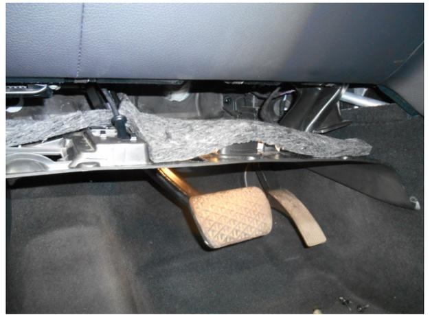
Отсоединить фишки, снять рычаг открывания капота, снять нижнюю панель.
