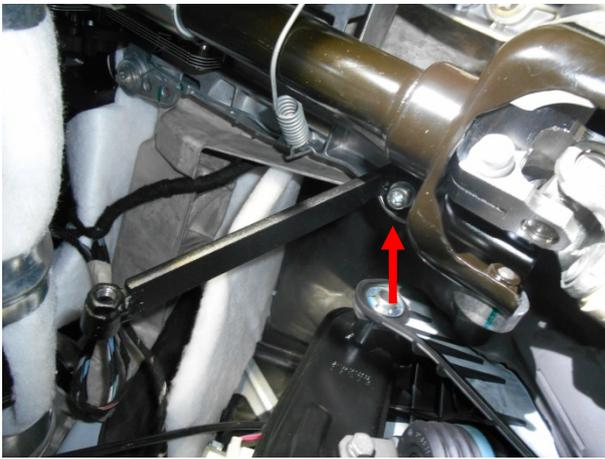
Установить и притянуть верхнее крепление срывным болтом с шайбой.
