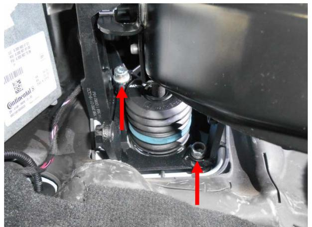
Установить кронштейн и затянуть срывной гайкой и срывным болтом с шайбой.
