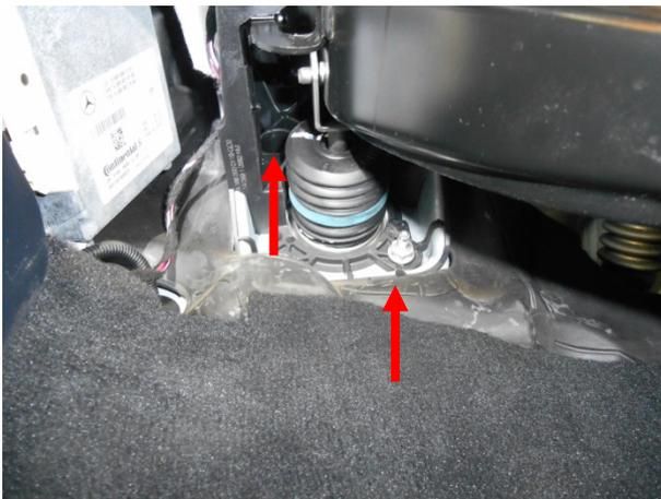
Вывернуть гайки крепления вакуумного усилителя.
