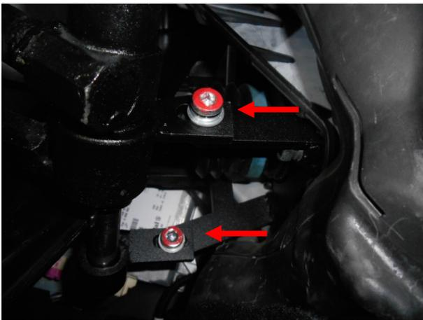
Притянуть замок к кронштейну особыми срывными болтами с шайбами.
