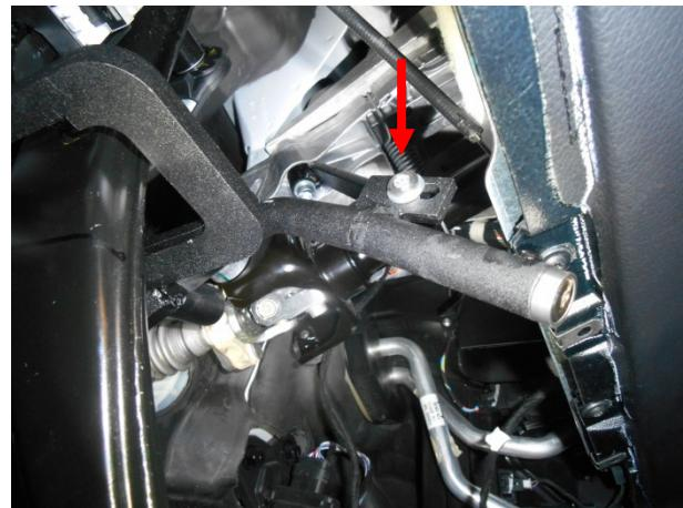
Притянуть верхнее крепление замка срываемыми болтами.
