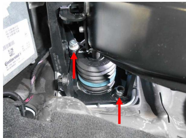
Установить кронштейн и затянуть сривной гайкой и сривным болтом с шайбой.
