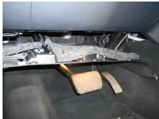
Отсоединить фишку, снять рычаг открывания капота, снять нижнюю панель.
