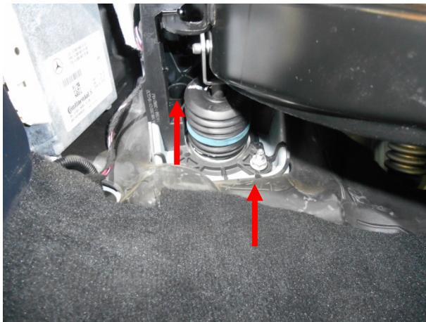
Вывернуть гайки крепления вакуумного усилителя.
