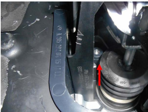
Установить и затянуть резьбовую втулку на левую верхнюю шпильку.
