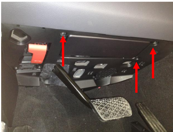
Вывернуть 2 самореза. Выдернуть клипсу. Снять панель, отсоединить фишки.
