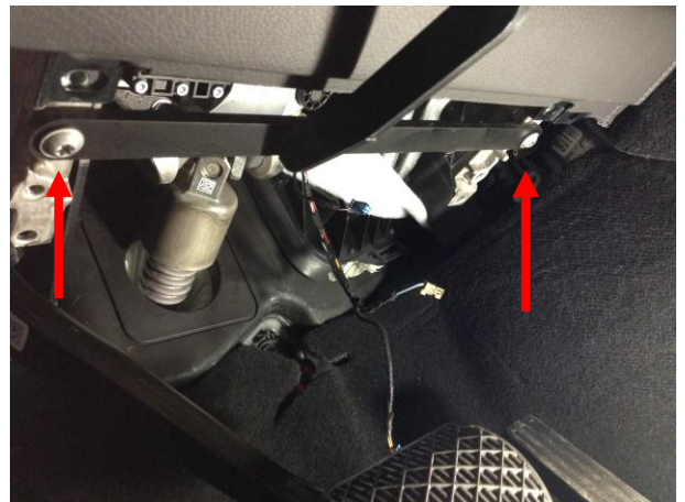
Установить инструмент для разметки панели.
