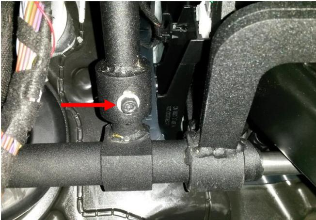
Отрегулировать выход цилиндра из панели и затянуть указанный болт. (оптимально выход цилиндра за пределы панели- 4 мм.)
