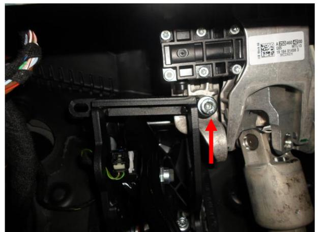
Затянуть срывным болтом с шайбой верхнее крепление.
