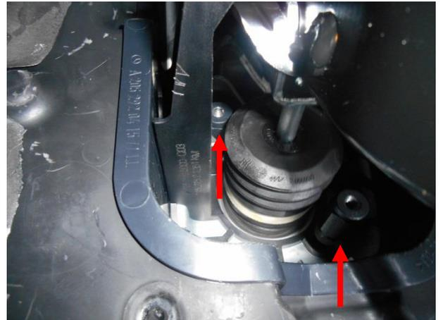
Установить и затянуть резьбовые втулки на шпильки вакуумного усилителя.
