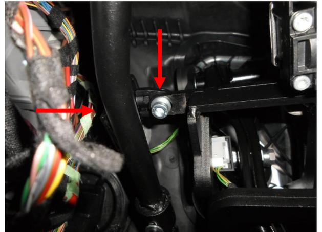
Притянуть верхнее крепление при помощи 2 срывных болтов.
