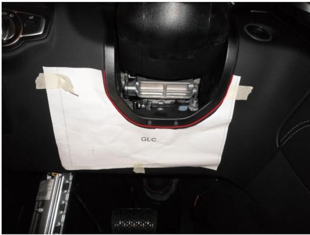
При помощи спец. трафарета разметить панель, и выполнить отверстие Ø20 мм.
