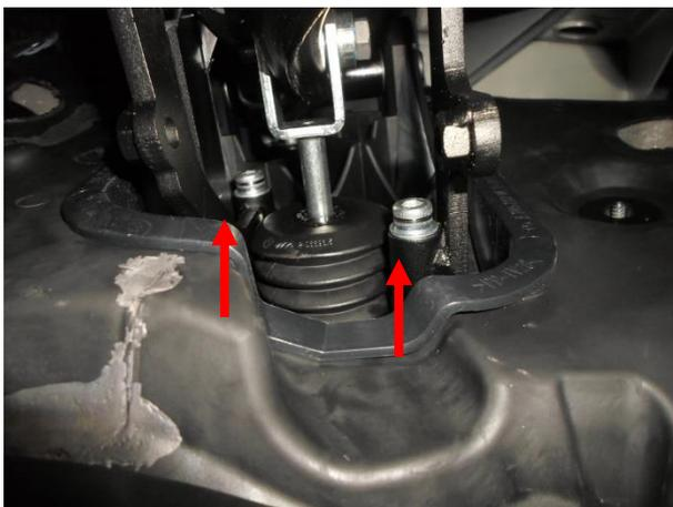
Установить кронштейн и затянуть срывными болтами с шайбами нижнее крепление.
