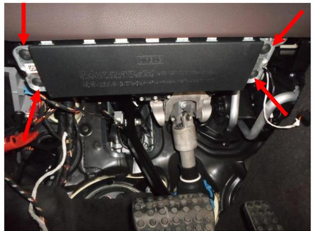
Вывернуть 4 болта, снять подушку Airbag.
