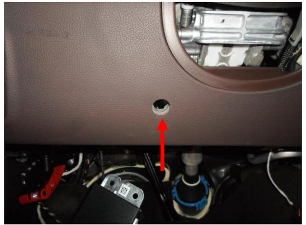
Выполнить отверстие Ø20 мм.
