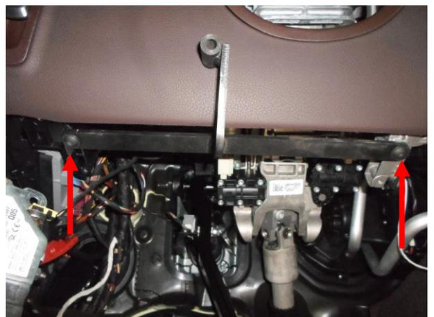
Установить инструмент для разметки панели.
