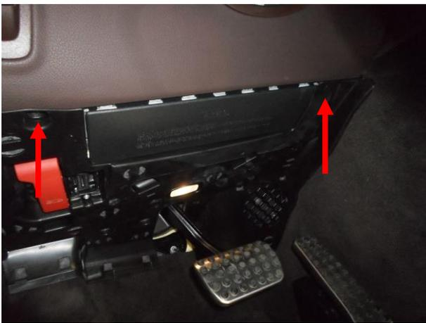
Вывернуть саморезы. Снять панель, отсоединить фишки.
