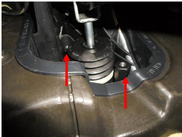
Установить и затянуть резьбовые втулки на шпильки вакуумного усилителя.
