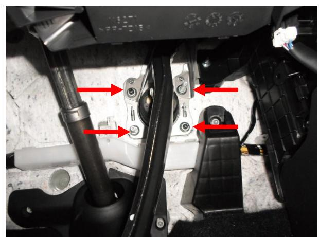
Отвернуть 4 гайки.
