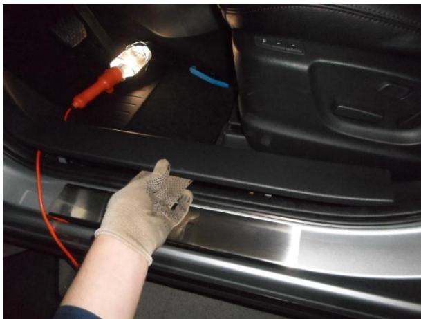
Снять накладку порога.
