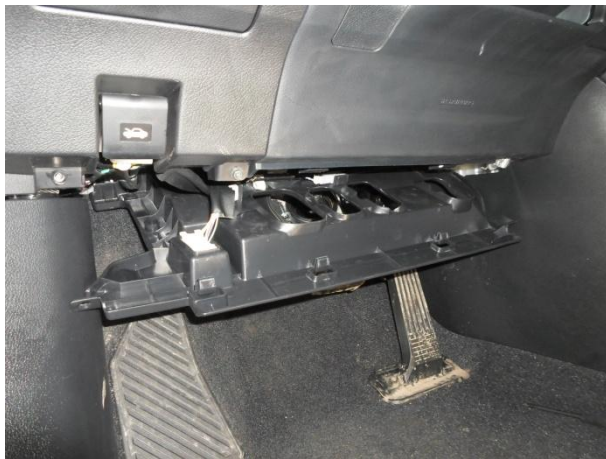
Снять панель, отсоединить фишки.
