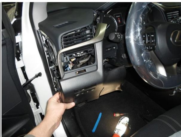
Снять панель, отсоединить фишки.
