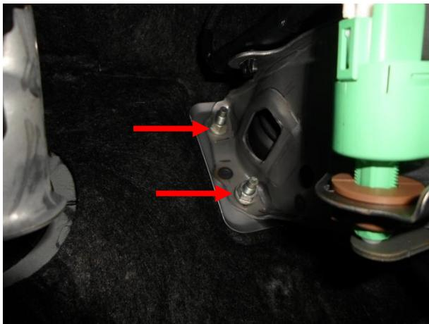
Отвернуть 2 гайки.
