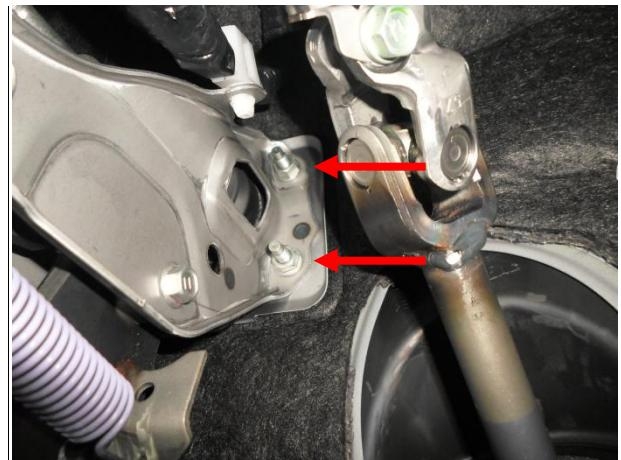
Отвернуть 2 гайки.
