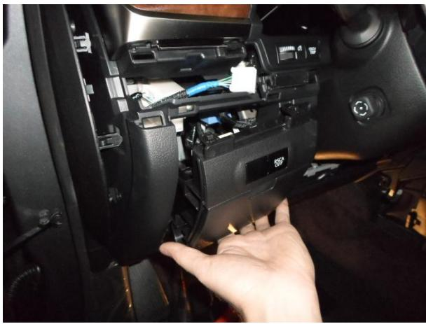
Снять панель, отсоединить фишкы.
