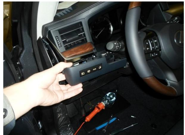
Снять панель. Отсоединить фишки.
