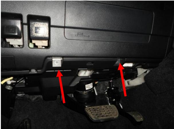
Вывернуть 2 самореза. Снять панель.
