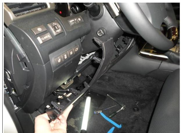
Снять панель, отсоединить фишкы.
