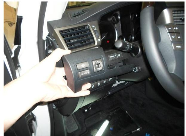
Снять панель. Отсоединить фишкы.
