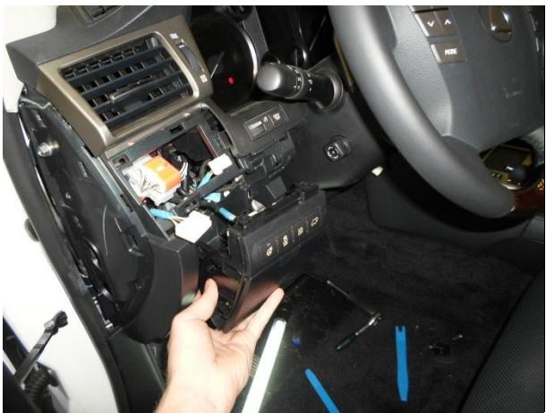
Снять панель, отсоединить фишкы.
