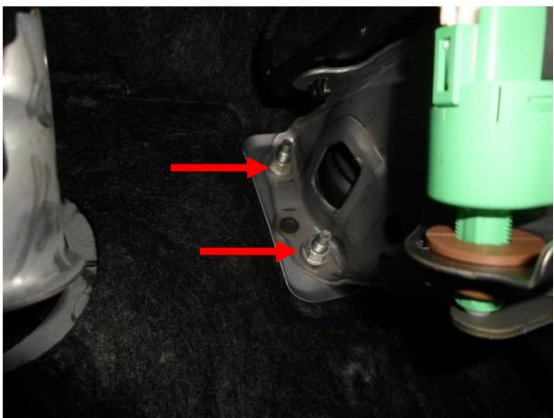
Отвернуть 2 гайки.
