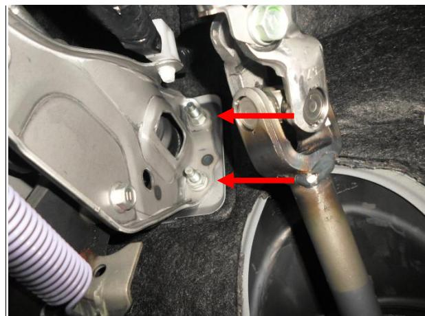
Отвернуть 2 гайки.
