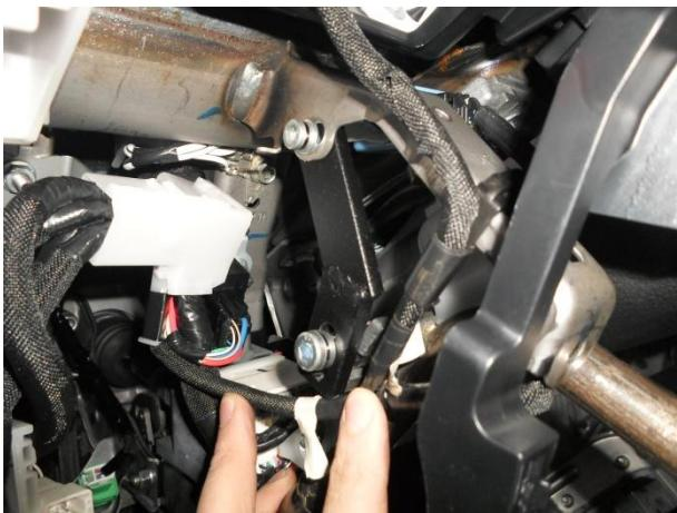
Установить регулировочную пластину.
