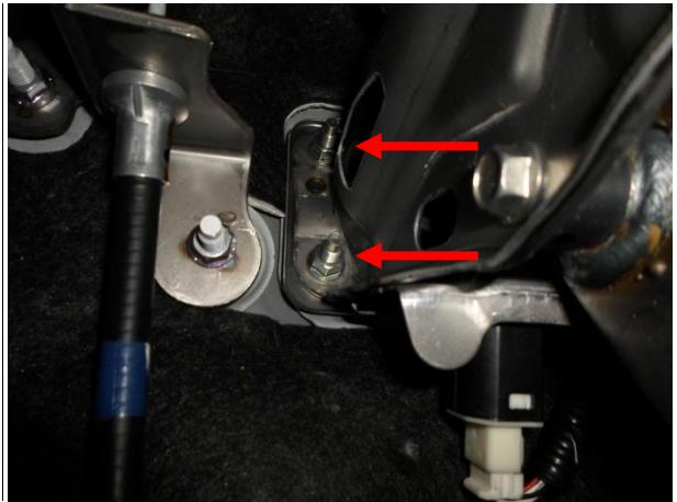
Отвернуть 4 гайки крепления электро усилителя тормозов.
