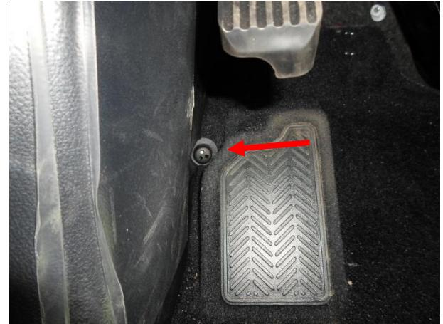
Снять накладку порога.
