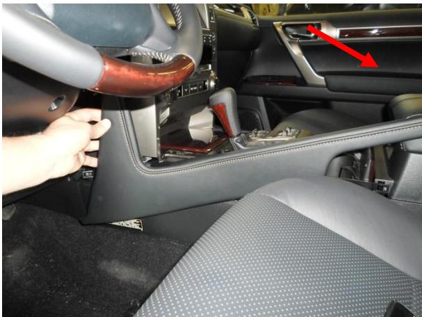
Вывернуть саморез, снять панель.
