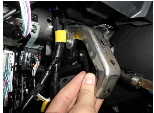
Притянуть замок срывным болтом при помощи пластины с резьбой.
