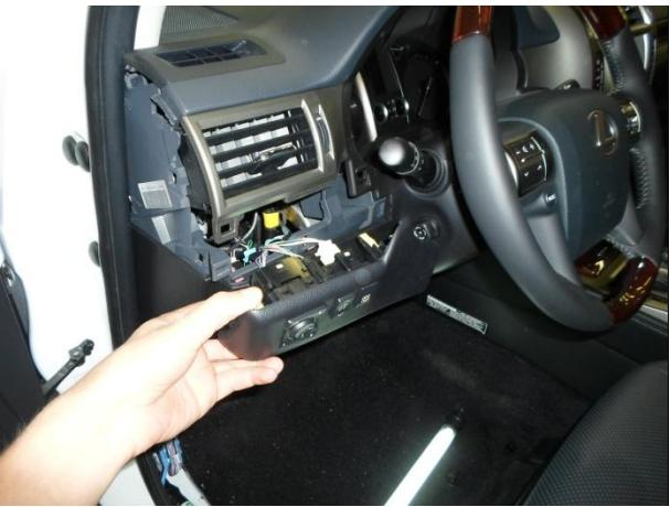
Снять панель, отсоединить фишкы.
