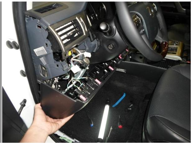
Снять панель, отсоединить фишкы.
