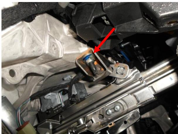
Отвернуть гайку крепления рулевой
