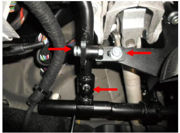
Притянуть замок к верхней части кронштейна. Отрегулировать выход цилиндра из панели и затянуть болт М5. (оптимальный выход цилиндра за пределы панели-4 мм.)
