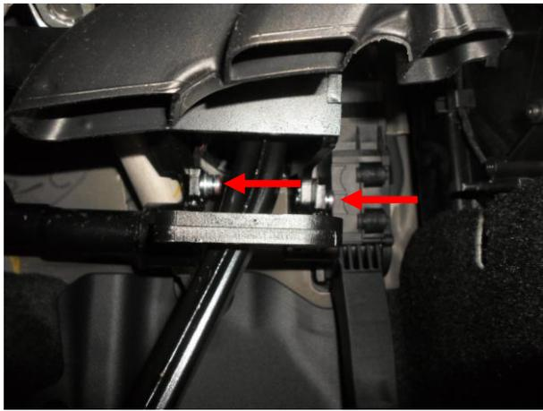
Притянуть замок срывными болтами к нижней части кронштейна.
