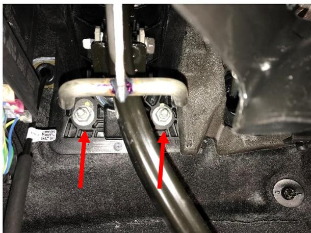
Отвернуть 2 гайки.
