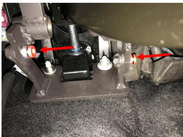
Установить блокиратор, притянуть срывными болтами M8x20.
