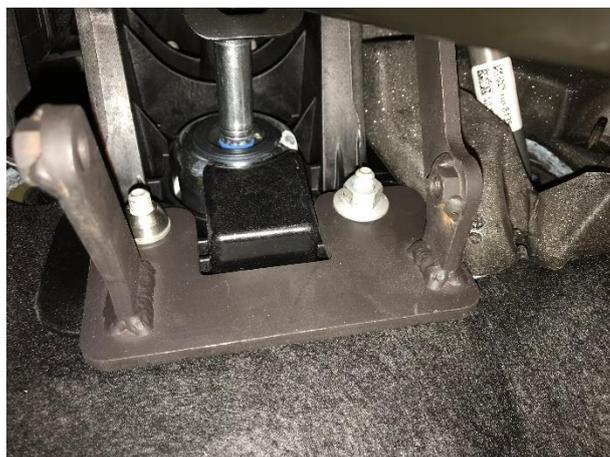
Установить крепление замка, притянуть срывными гайками...
