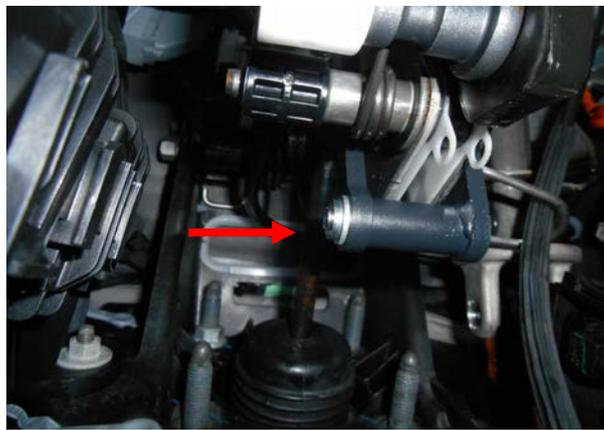
Установить левую половину флажка и притянуть болтами. Использовать для переднего верхнего крепления (без втулки) несрывной болт, затянуть его, не деформировав направляющую педали. Срывные болты (со втулками) оборвать.
