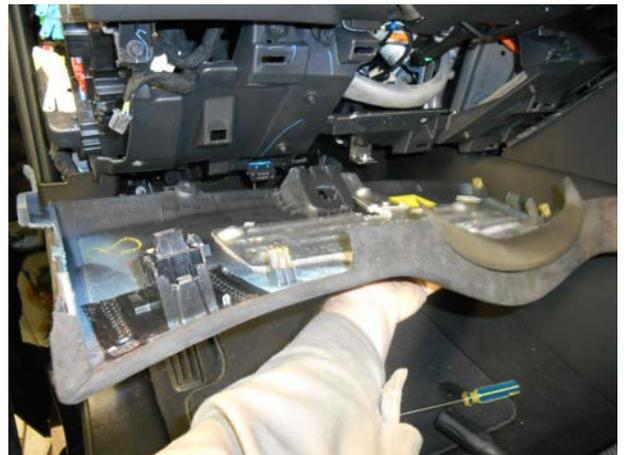
Отсоединить фишки, снять нижнюю панель.
