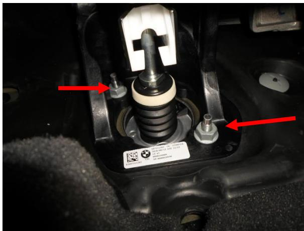
Отвернуть 2 гайки.
