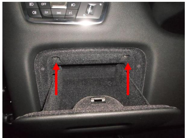
Вывернуть 2 самореза, снять перчаточный ящик.
