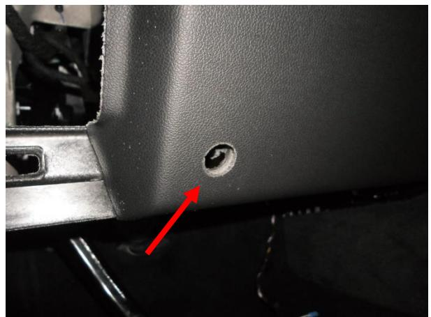
Выполнить отверстие Ø20 мм.
