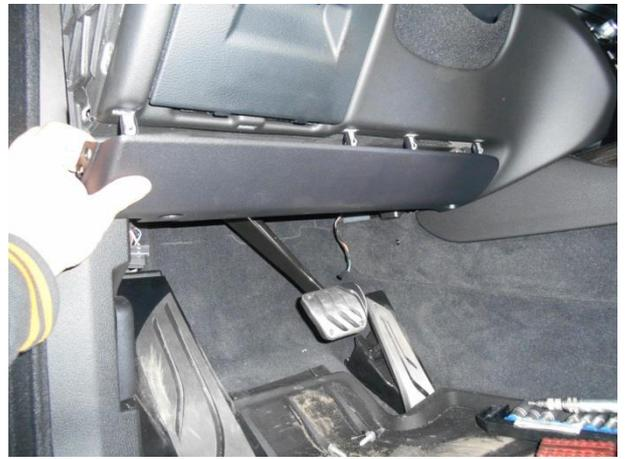
Снять боковину панели, отсоединить фишки, снять нижние панели.
