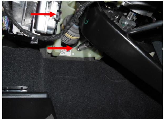
Отвернуть две гайки крепления вакуумного усилителя.
