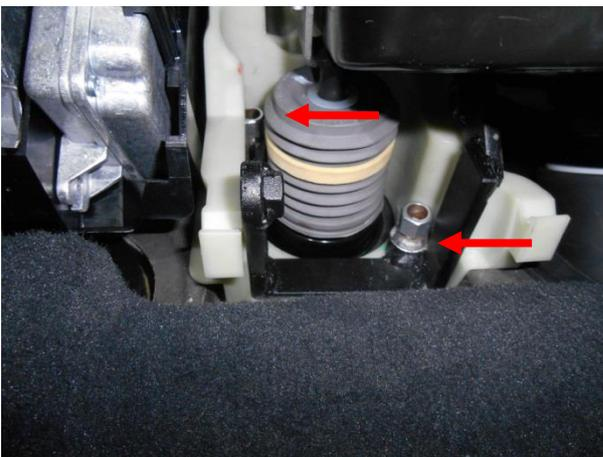
Установить кронштейн на шпильки и затянуть срывными гайками.
