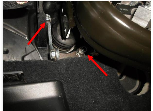
Притянуть нижнее крепление срывными гайками.
