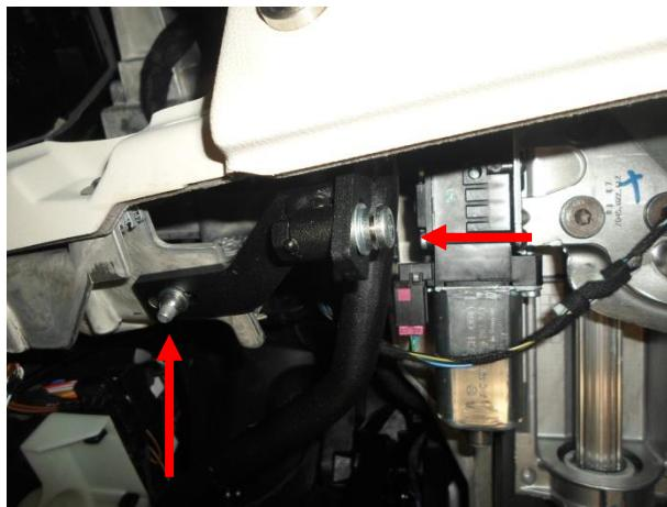
Установить дополнительное крепление замка и притянуть к нему замок.
