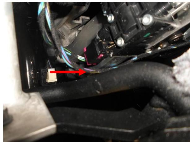
Проверить наличие зазора между гусем и разъемом при разных регулировках положения руля.
