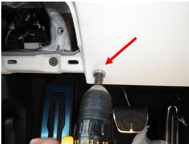
Выполнить отверстие в панели Ø20 мм.
