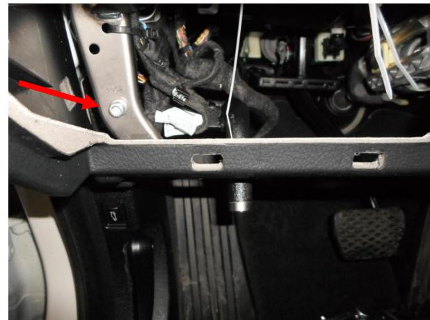
При регулировке блокиратора использовать дополнительный уголок с регулировкой.
