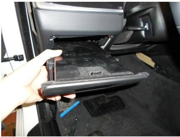
Снять перчаточный ящик.
