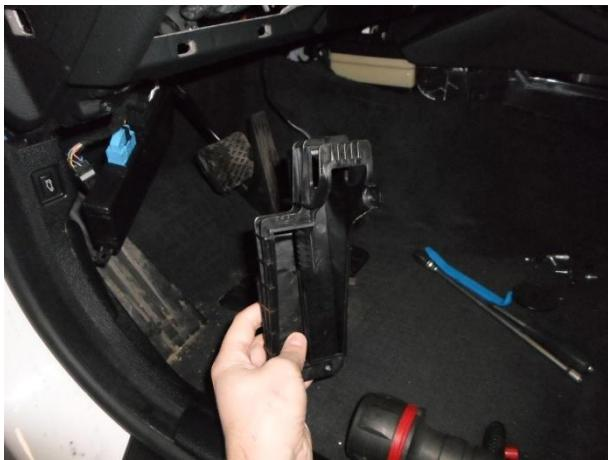
Вывернуть 3 самореза, снять кронштейн ЭБУ.
