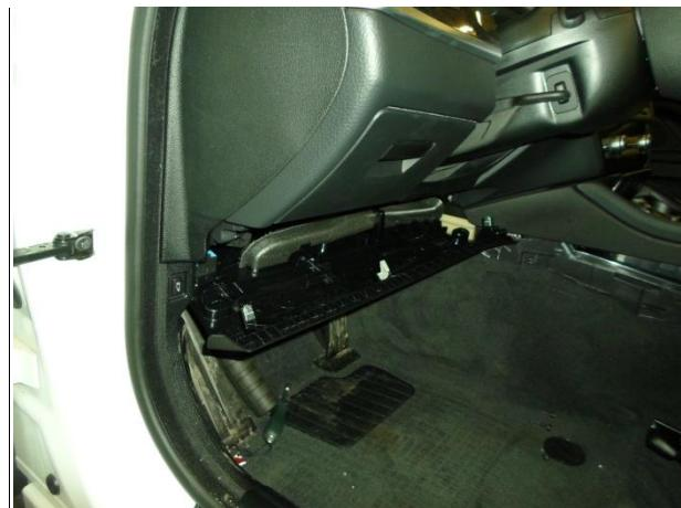
Снять панель, отсоединить фишкы.
