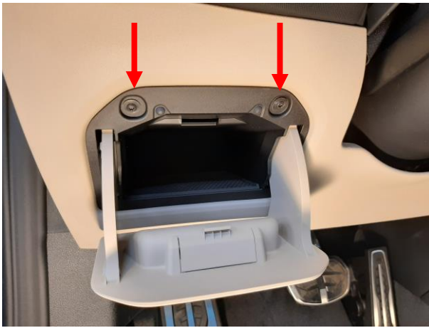
Вывернуть 2 самореза, вытащить перчаточный ящик.
