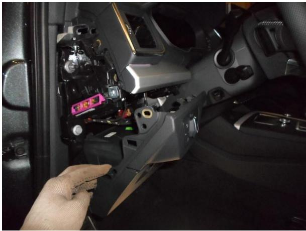
Снять панель, отсоединить фишку.
