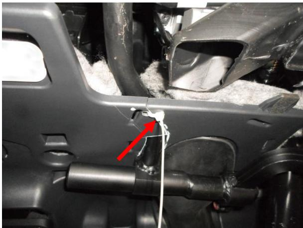
Зафиксировать разрез хомутом.
