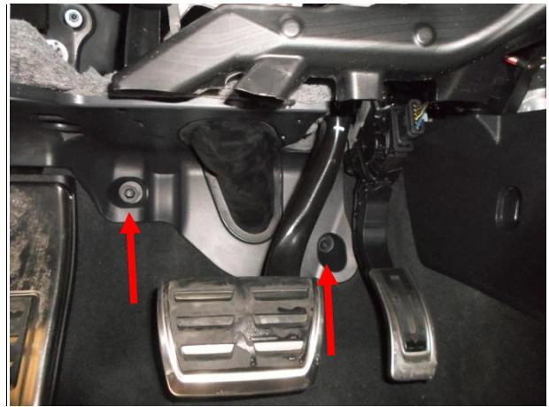
Отвернуть 2 гайки, снять панель, снять фишку.
