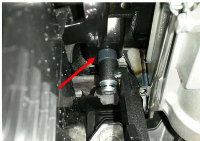
Если отсутствует крепление рулевой колонки с левой стороны - при установке верхнего крепления использовать втулку L-10 мм. из комплектации.
