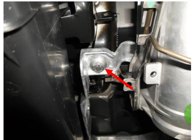
Вывернуть болт крепления рулевой колонки.
