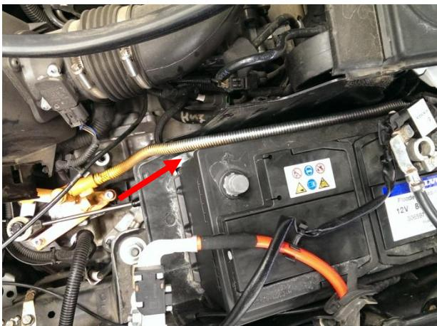
Установить аккумулятор на штатное место. Приподняв оболочку замка наверх закрутить болт крепления аккумулятора.
