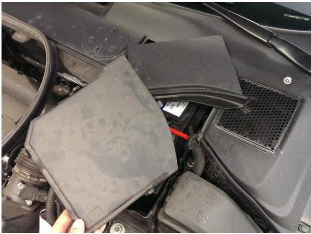
Снимите крышку аккумулятора.
