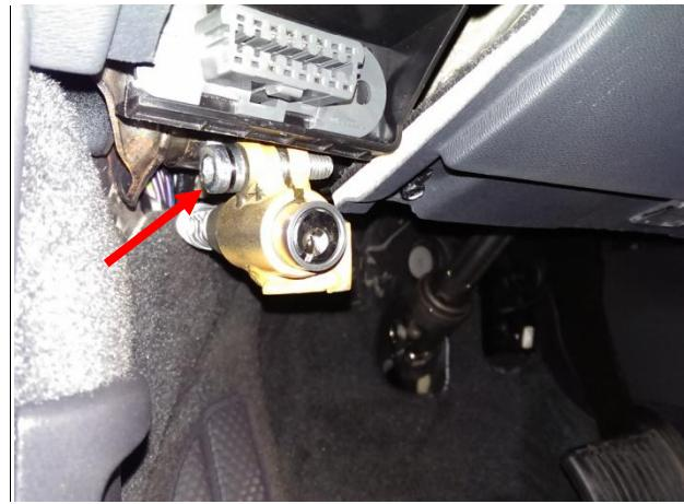
Просуньте замковый механизм через заглушку. Установить заглушку на штатное место. Установить замковый механизм в кронштейне, притянуть его срывным болтом. **Поворотом замкового механизма добиться нулевого выступания ригеля из корпуса, проверить лёгкость работы замка.**
