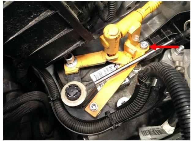
Установить кронштейн, притянув срывными болтами (под точку крепления кронштейна, обозначенный стрелкой, подложить широкую шайбу).
