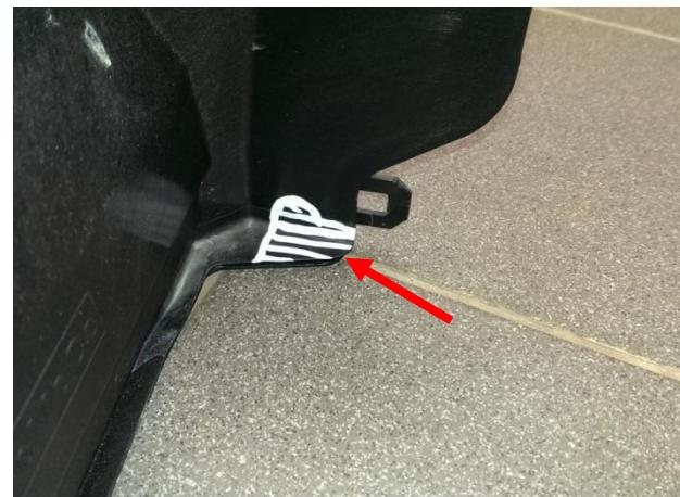
Выполнить вырез в пластиковой стенке короба аккумулятора для выхода оболочки замка.
