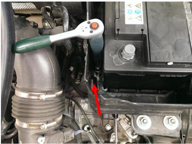
Открутите болт крепления аккумулятора,
