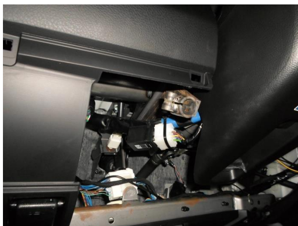
Установить кронштейн и притянуть срывными болтом M8x30 и гайкой.
