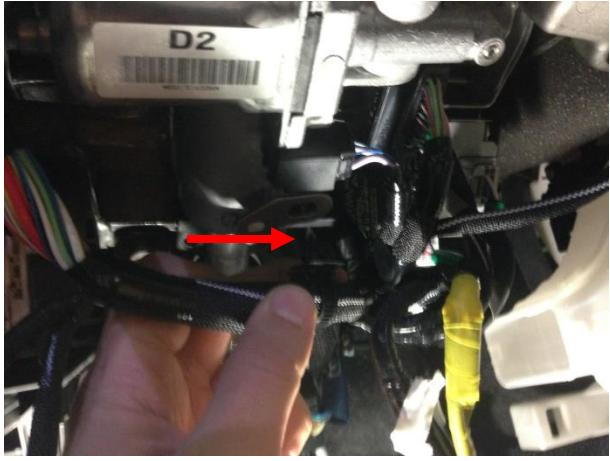
Снять жгут проводов.
