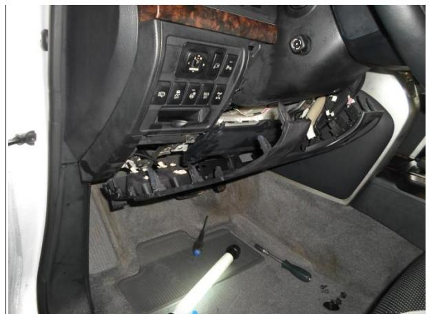
Снять панель, отсоединить фишкы.
