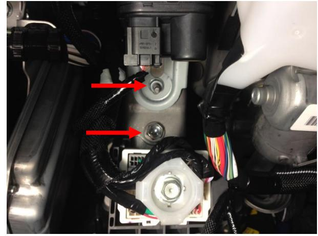
Отвернуть гайку, снять реле. Вывернуть болт.
