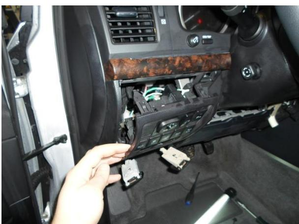
Снять панель, отсоединить фишкы.
