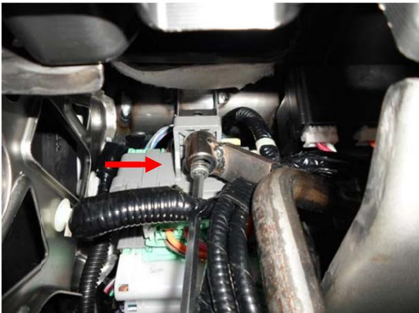
Притянуть переднее крепление замка, установив между замков и корпусом широкую шайбу.
