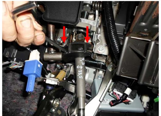
Установить рулевой вал в положение «прямо». Установить блокирующую муфту, **проверить свободное вращение рулевого вала при разных регулировках положений руля** и сорвать крепеж муфты и замка.
