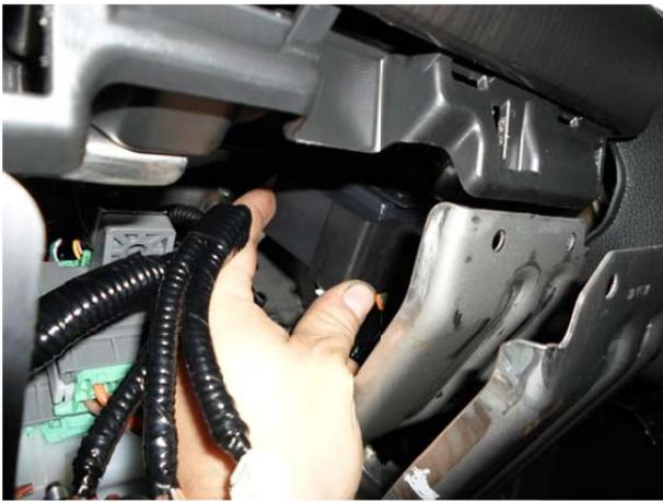
Снять блок с направляющих.
