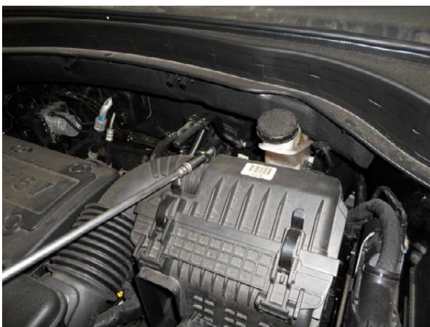
Ослабить верхнее крепление хомута воздушного патрубка.
