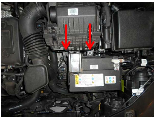
Вывернуть болты крепления воздушного фильтра.
