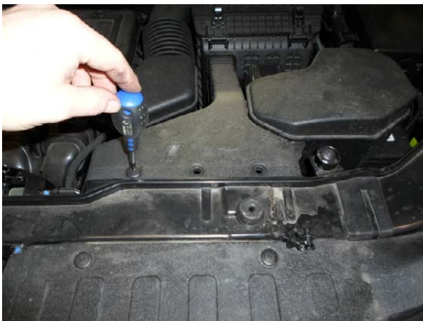
Вывернуть 3 клипсы крепления воздухозаборника.
