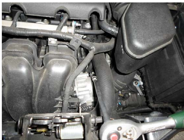
Ослабить нижнее крепление хомута воздушного патрубка.
