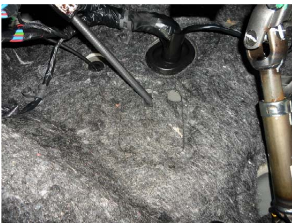
Установить в отверстие в моторном щите уплотнительное кольцо, вернуть на место шумоизоляцию.
