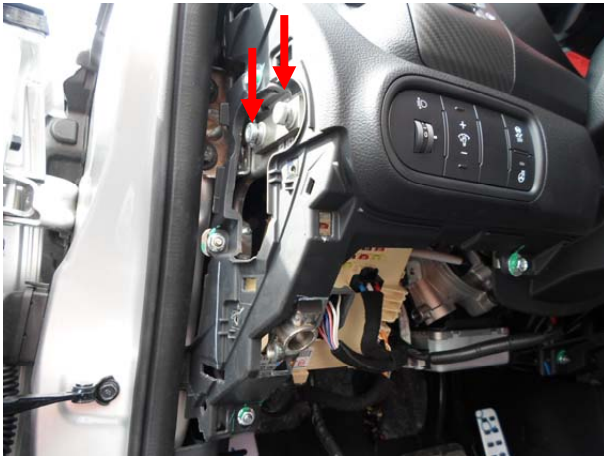
Притянуть кронштейн срывными болтами.
