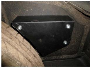
Установить защиту запасного колеса и притянуть срывными болтами.
