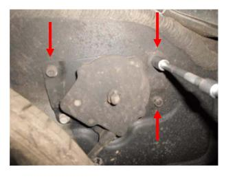
В задней части автомобиля, снизу багажного отделения вывернуть три болта .
