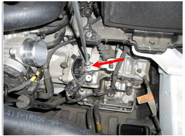
Отвернуть гайку и заменить ее срывной.
