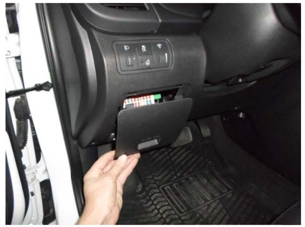
Снять крышку блока предохранителей.
