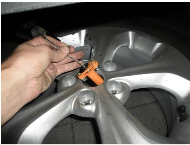
При установке запасного колеса вставляем защитный элемент. (в сборе)
