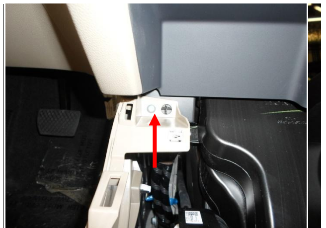
Вывернуть саморез и отвести панель в сторону.
