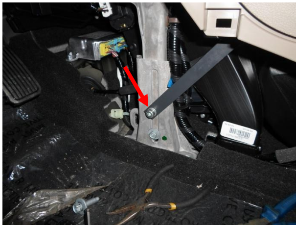
Притянуть замок срывным болтом.
