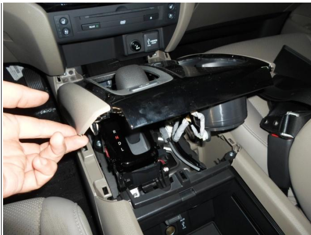
Снять панель, отсоединить фишки.
