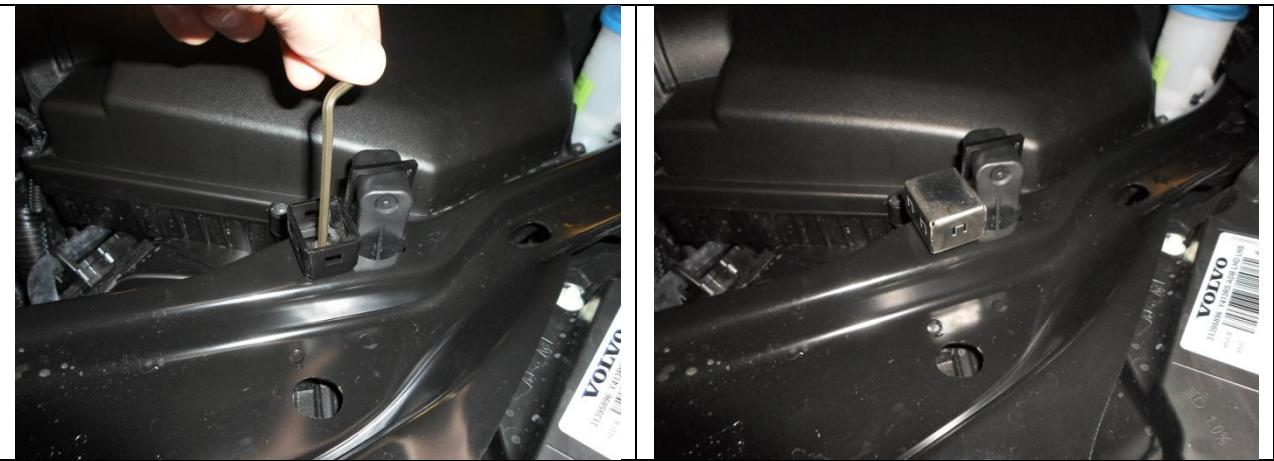
Затянуть болт, используя ключ из комплектации.
