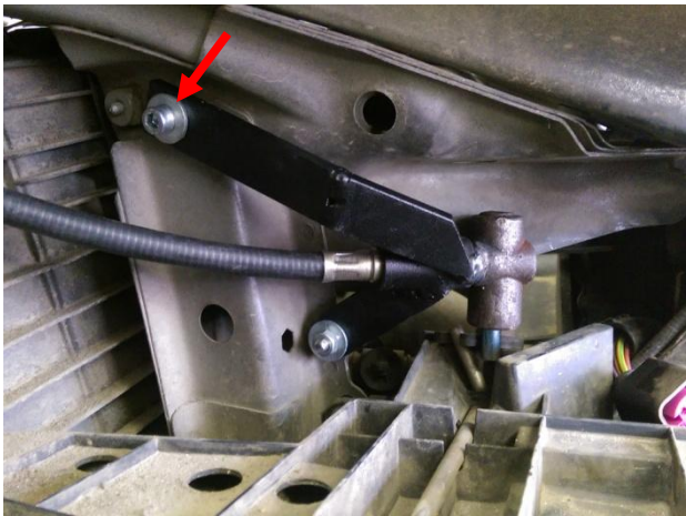
Закрепить замок с помощью болтов. Под верхнюю левую точку крепления замка подложить втулку.
