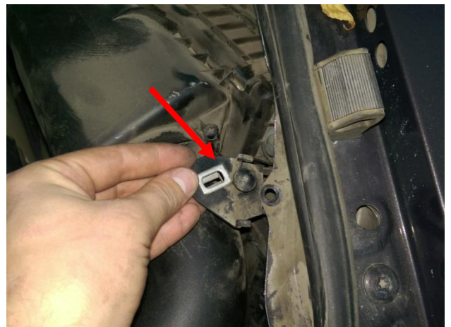
Выкрутить винт. Снять крепление. Снять правую фару а/м.
