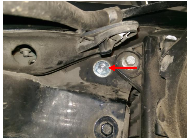
С другой стороны привернуть гайку с шайбой.
