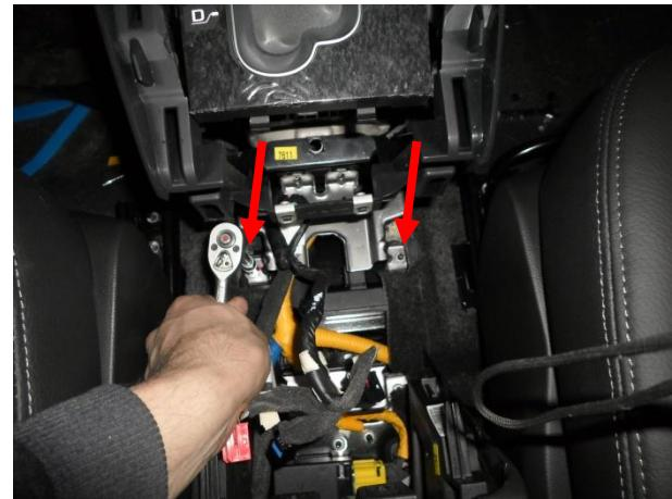
Отвернуть две гайки.
