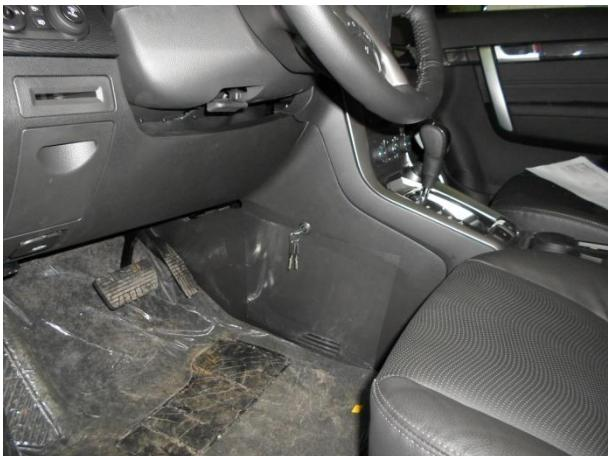
Затянуть болты до отрыва головок, собрать все в обратной последовательности, одень декоративную накладку.
