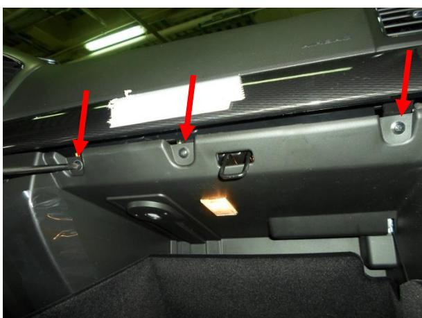
Вывернуть три самореза, снять
