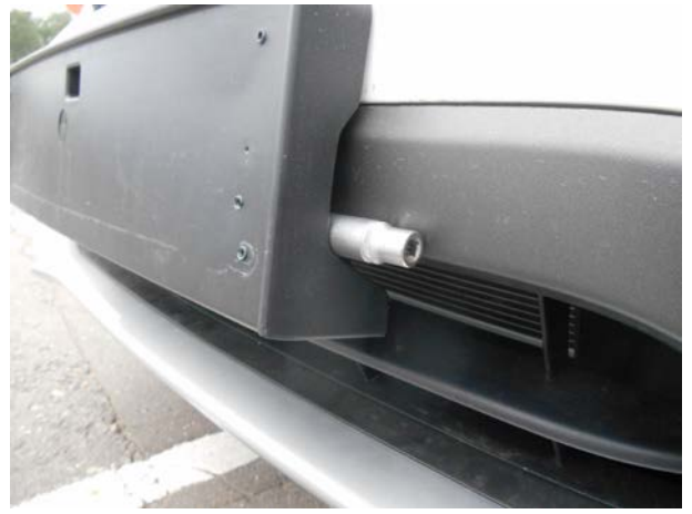
Отодвинуть площадку номерного знака.
