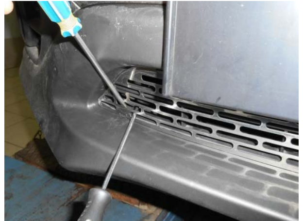
Придерживая решетку одной отверткой, другой отверткой загнуть крючок.
