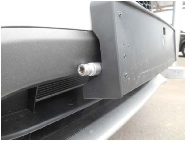
Отодвинуть площадку номерного знака.
