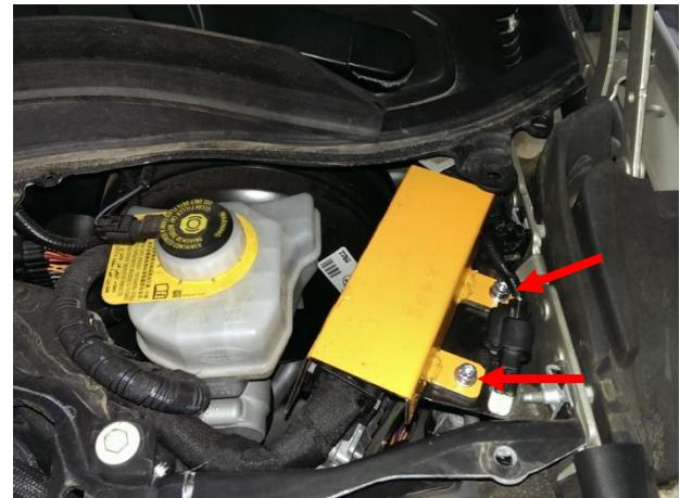
Установить кронштейн, притянув срываными болтами. Закрутить крепеж до отрыва головок.
