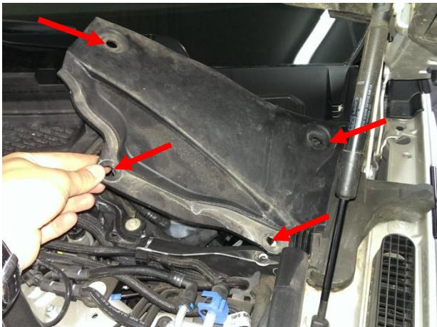
Снять крышку, выкрутив клипсы.
