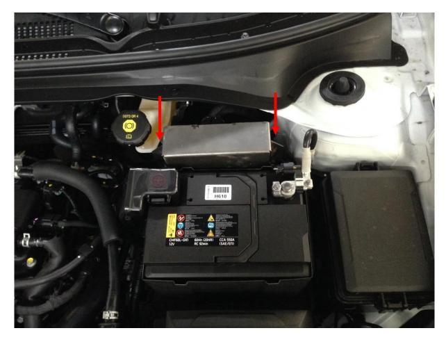
Установить защиту на шпильки, притянуть защиту срывными гайками из комплектации. Закругить крепеж до отрыва головок.
